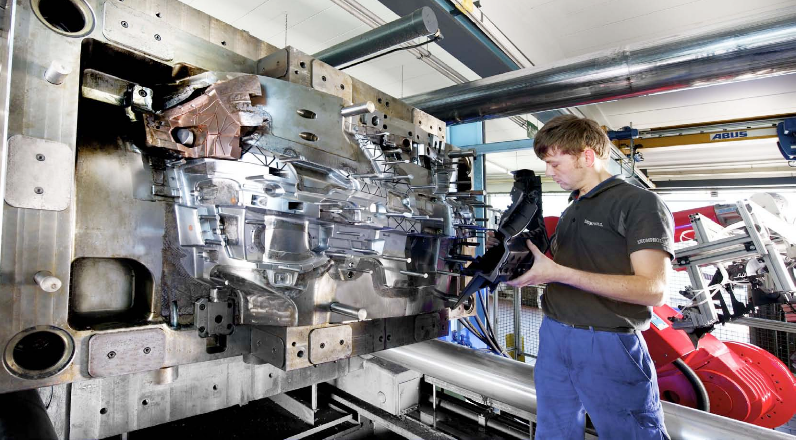
Um Kunststoffbauteile für den Stoßfänger eines neuen Elektrofahrzeugs zu fertigen, benötigte Krumpholz drei neue Spritzgießwerkzeuge. Bilder: Krumpholz
